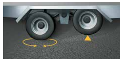
Hinterachse mit optionaler Lifieinrichtung: Ermöglicht ein leichtes Rangieren des Anhängers per Hand.
